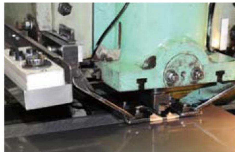
金 属の板をパンチプレス機に掛け、さまざまなかたちの穴を打ち抜いて、金網のようなパターンを形づくる「パンチングメタル」(打抜金網)。
